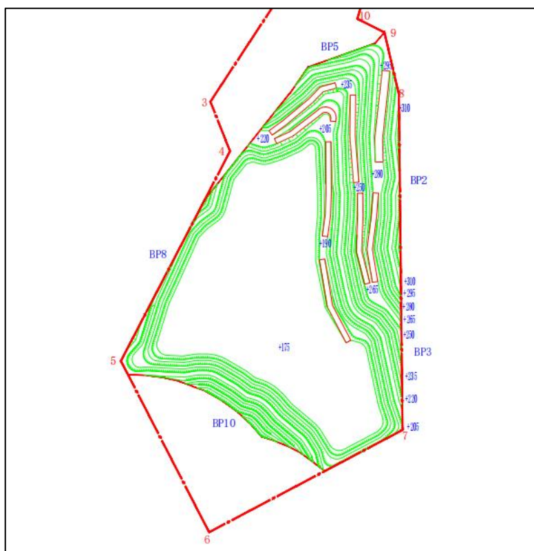
图 3-7 南侧露天采场边坡分段图
