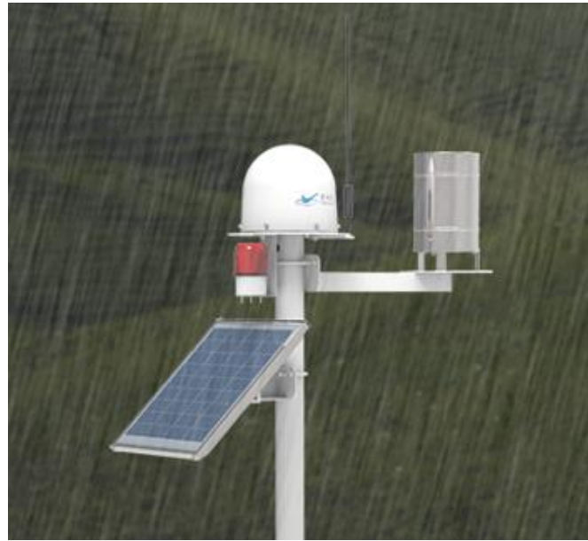
图 5-3 雨量计安装效果示意图
