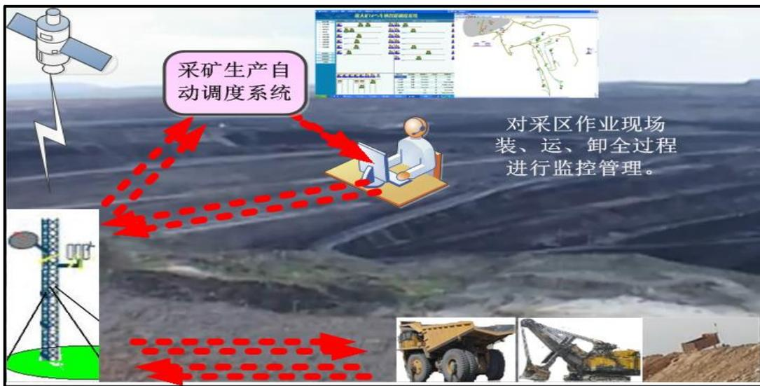
图 2-12 GPS 智能调度系统示意图
