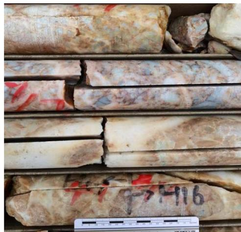
图 2-14：硅化构造角砾岩矿石
